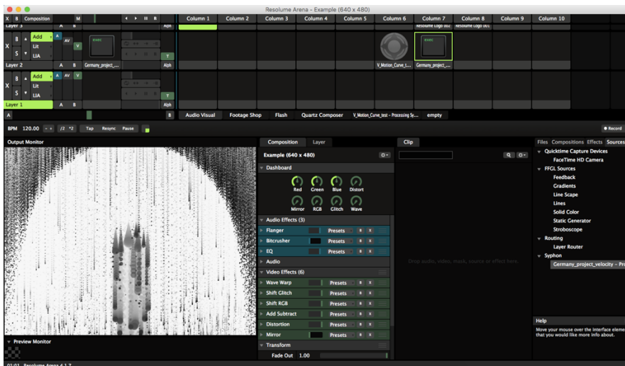
Abbildung 32: Das von Zixuan Nian in Echtzeit in Processing generierte Video, das zur visuellen Darstellung per Syphon der Software Resolume Arena zur Verfügung gestellt wird (frame sharing).
