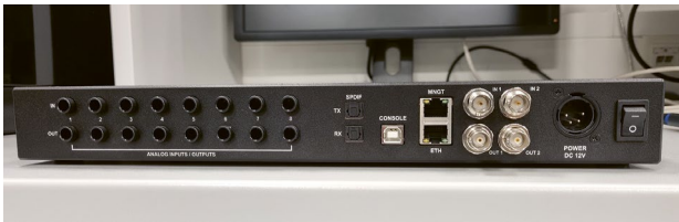
Abbildung 9: Rückansicht des MVTP-Geräts von cesnet mit den Audio-, Video- und Netzwerkschnittstellen
